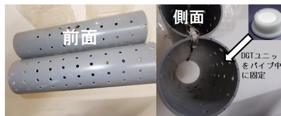
写真-1 DGTユニット取り付け用の観測機材
