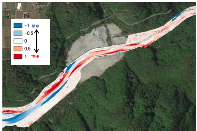
図-5 洪水前後の河床高の変化比較。上：河床変動計算結果 下：レーザープロファイラ計測による差分
