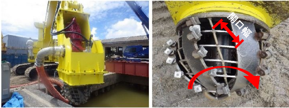
図-3 プロトタイプモデルアタッチメントの全体と先端部
