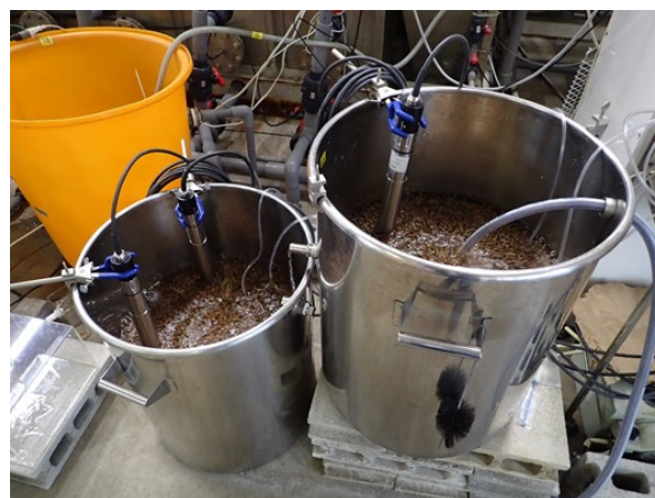
写真-1 微生物保持担体処理槽の外観
