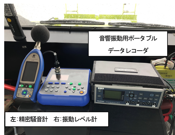
写真-6 運転室内機器設置状況
