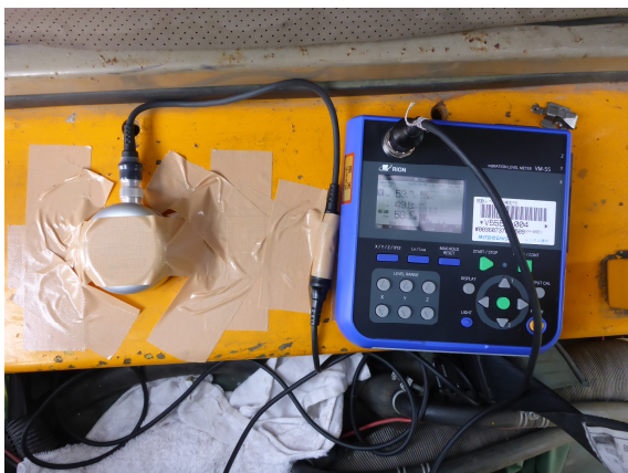
写真-3 振動レベル計 取付状況
