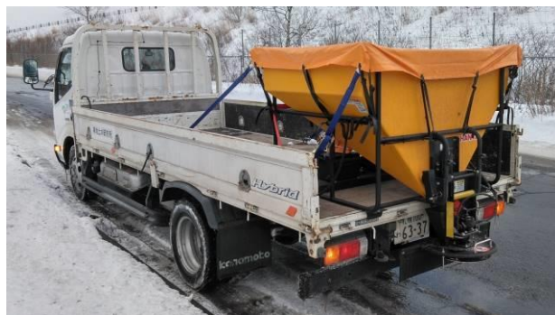
写真-8 車載式凍結防止剤散布装置
