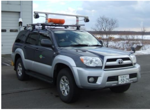
図6 道路有効幅員計測装置の取り付け状況
