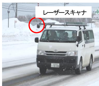
b. 冬期道路有効幅員計測装置
