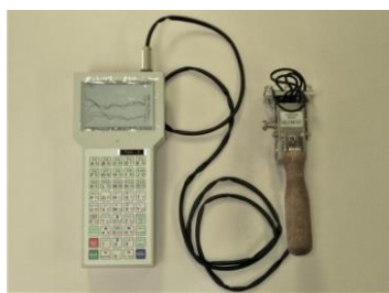
図-24 自己磁場測定型残留応力検出機
