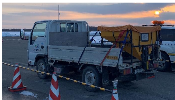
写真-12 検証に用いた試験車両(1.5トントラック)
