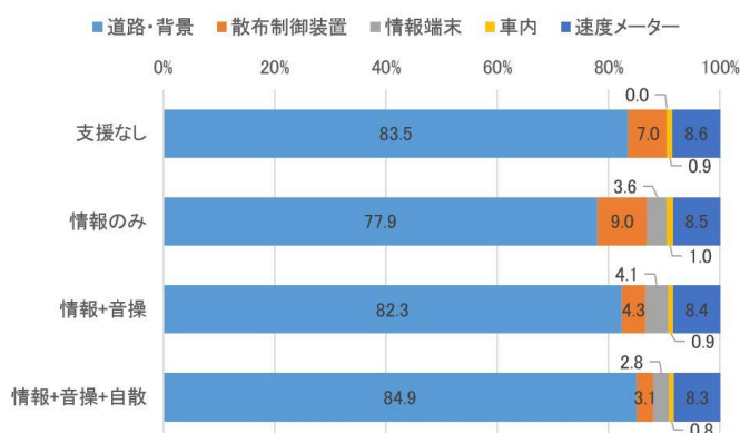
図-12 認知区間における散布作業支援の有無・種別による注視率
