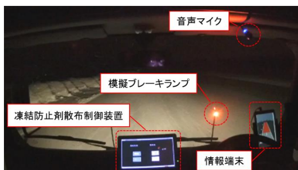
写真-6 車内に設置した凍結防止剤散布制御装置
