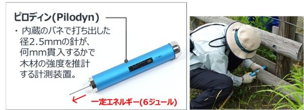
図-3 ピロディン計測器の概要と計測例
