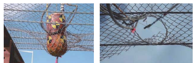
(a) 重錘を捕捉した場合 (b) 金網を貫通した場合
