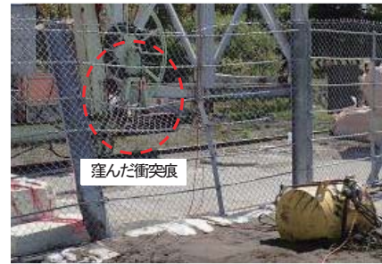
図-5 衝撃実験後の供試体と重錘
