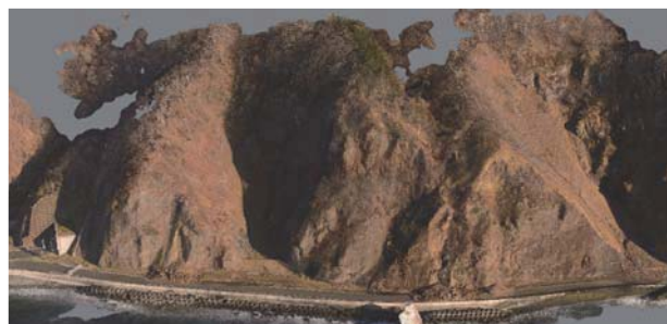
図-2 UAV 写真を表面に貼った三次元地形モデル
