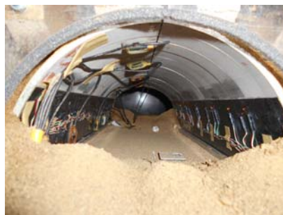
写真-12 CASE-2 加振後の内部状況
