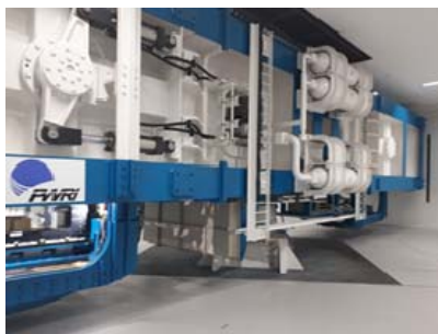
写真-5 遠心模型実験機
