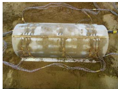
写真-14 CASE-2 加振後の状況
