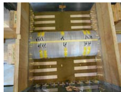
写真-8 带状補強材の配置状況
