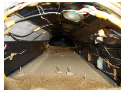
写真-13 CASE-3 加振後の内部状況
