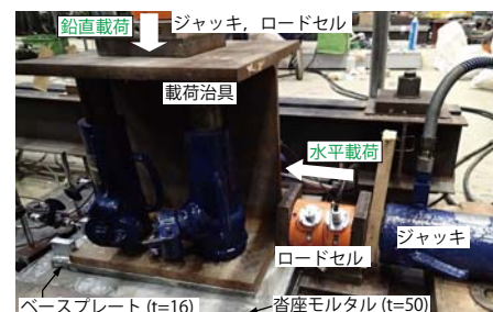
写真-4.1 実験装置のセットアップ状況
