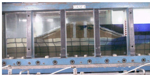
写真-4.4 Case4における100h付近の堤体状況写真
