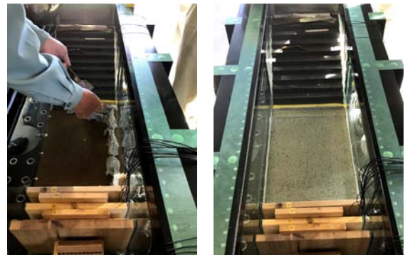
写真-2.5 難透水層の作製状況
