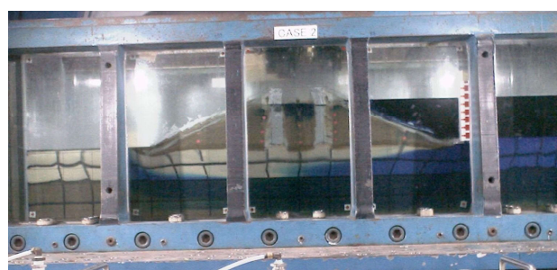
写真-4.3 Case2における150h付近の堤体状況写真
