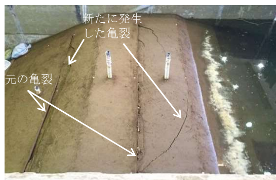
写真-2.2 実験中の亀裂の状況 (Case4-2)
