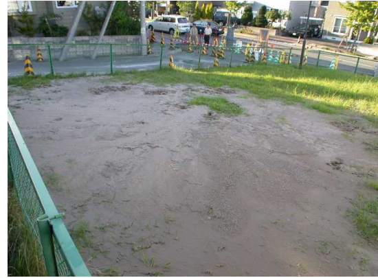
図-2.17 2011年十勝沖地震による調査箇所②の噴砂 (文献21)の写真4.2.5)
