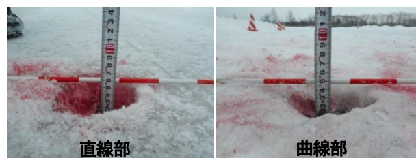
写真-13 走行車線積雪状況
