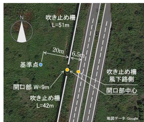
図 17 観測機器設置状況
