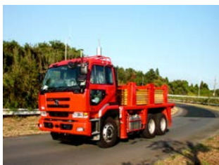
写真-16 荷重車による耐久性試験
