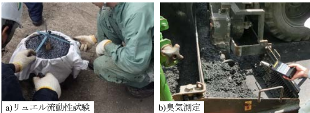
写真-11 施工時材料性状測定状況
