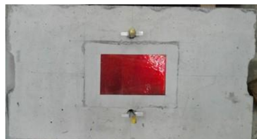
図-3.14 補修材を塗布したコンクリート供試体
