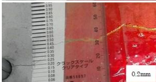
図-3.30 補修材厚さ 160µm（中塗り）のひび割れ
