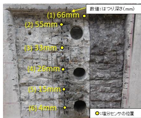
図-2.14 はつり深さと塩分センサの測定位置
