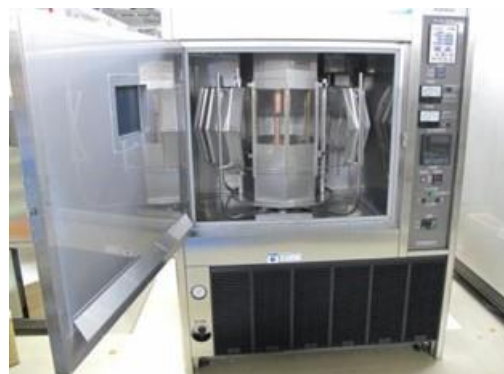
図-3.9 耐候性試験機の概要
