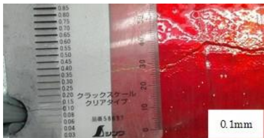
図-3.29 補修材厚み無しのひび割れ可視化
