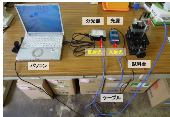
図-3.11 ファイバー分光器による波長計測
