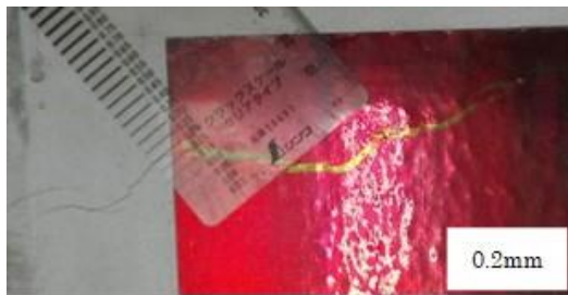
図-3.29 補修材厚み無しのひび割れ可視化
