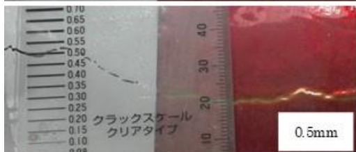
図-3.31 補修材厚さ 190µm（中塗り+上塗り）のひび割れ可視化
