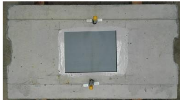
図-3.7 補修材を塗布したコンクリート供試体
