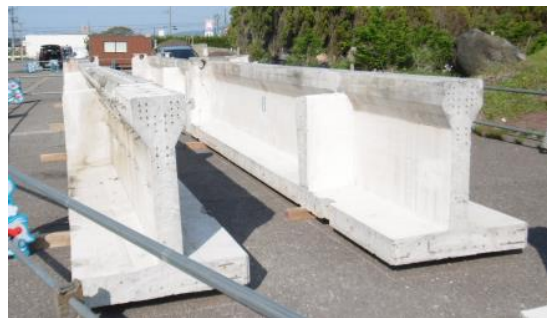
図-2.18 第5章で測定対象とした部材の設置状況(上下反転して設置)
