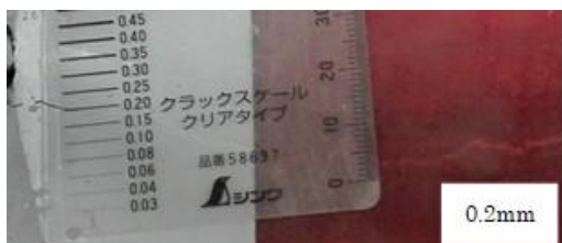
図-3.30 補修材厚さ 160µm（中塗り）のひび割れ
