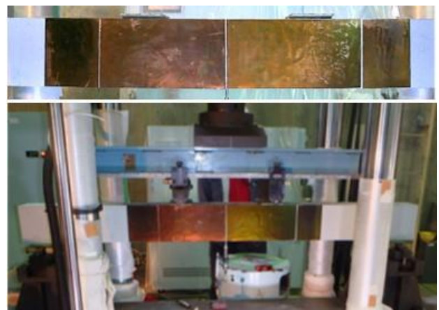
図-3.13 オパール薄膜の貼付状況(上)と載荷試験(下)
