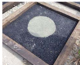
写真 3-3 模擬層間剥離作成
