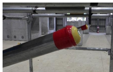
写真-2 単管の密閉状況
