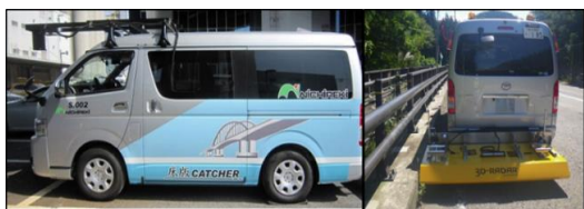
写真-6 車載式電磁波レーダ外観
