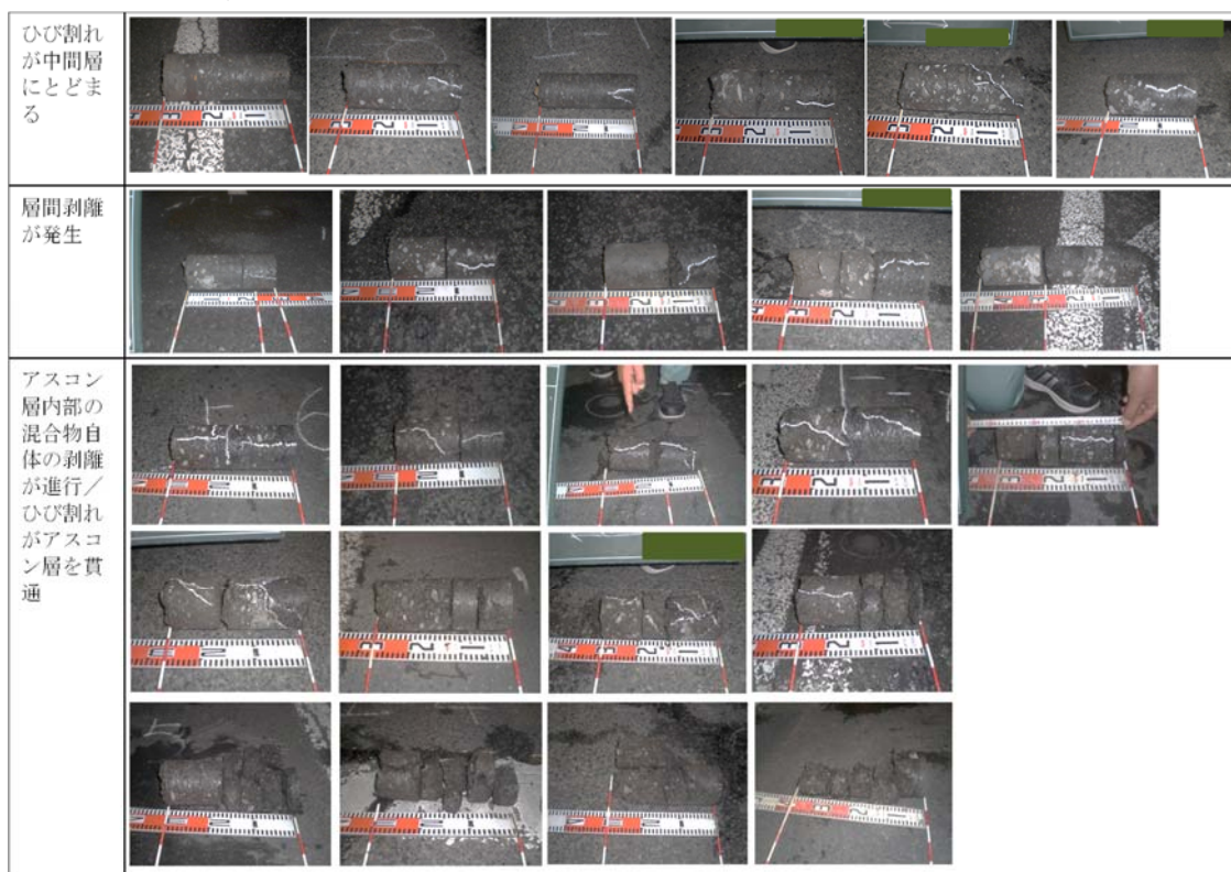
図 2-2 コア抜き調査結果
