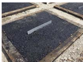
写真 3-1 模擬ひび割れ作成
