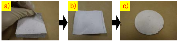
a)、b) 試験片から塗装を採取 c) φ60mm に成形
