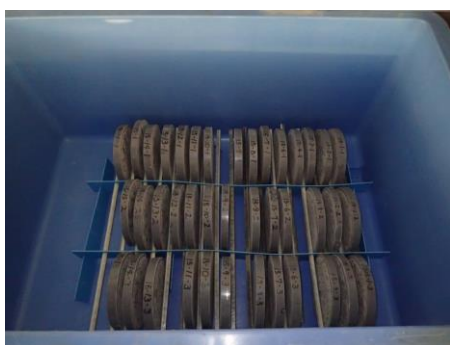
図 2-2 浸せき試験時の試験片設置状況
