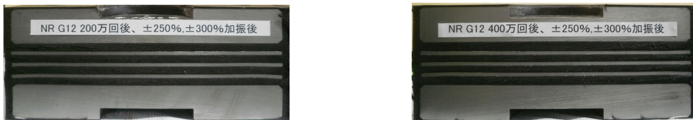
(a) 常温環境の200万回の繰返し载荷を受けた断面 (b) 低温環境の400万回の繰返し载荷を受けた断面 図-3.29 RB(NR) ゴム支承の極限せん断試験後の断面切断写真
