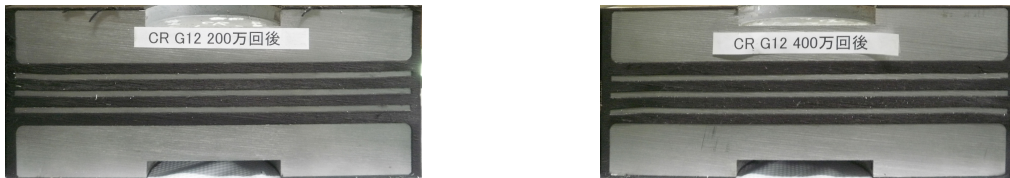
(a) 常温環境の200万回の繰返し载荷を受けた断面 (b) 低温環境の400万回の繰返し载荷を受けた断面 図-3.30 RB(CR) ゴム支承の極限せん断試験後の断面切断写真
