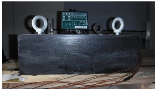
図-4.3 施工後 30 分の表面状況
