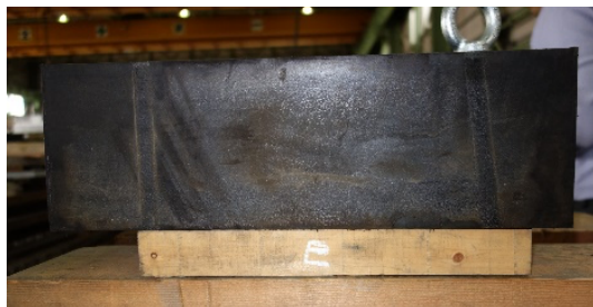
図-4.8 加振後の補修剤の付着状況写真
