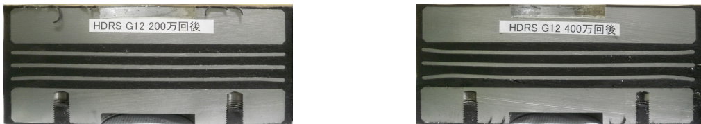
(a) 常温環境の200万回の繰返し载荷を受けた断面 (b) 低温環境の400万回の繰返し载荷を受けた断面 図-3.31 HDR ゴム支承の極限せん断試験後の断面切断写真
