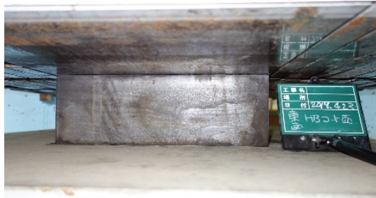
図-4.6 せん断試験前の状況写真
