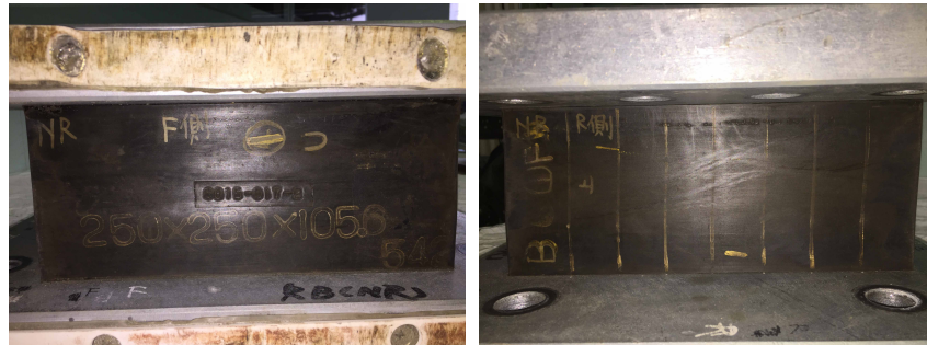
a) RB(NR) (左; 橋軸面, 右; 橋軸直角面)
