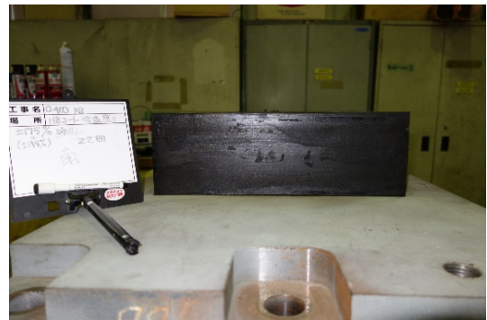
図-4.10 ±175%加振後の補修剤付着状況写真
