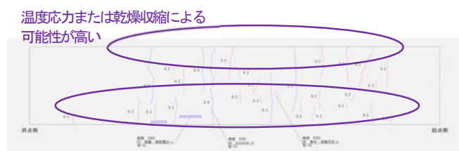
図-3 側壁のひびわれの例
