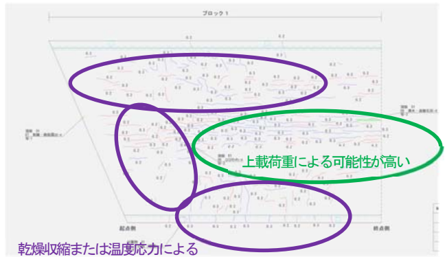
(a) 上載荷重によるひびわれおよび乾燥収縮または温度応力によるひびわれ
