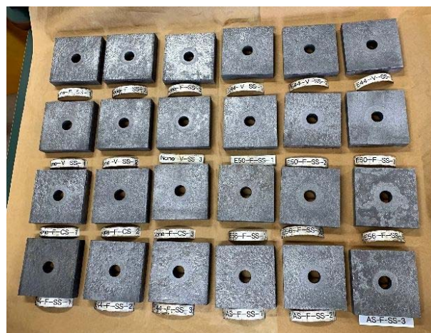
写真-2 腐食生成物除去後の試験体
