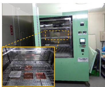
写真-3.3 凍結融解試験機の全景とその内部
