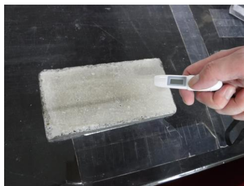
写真-4.4 表面温度の測定状況
