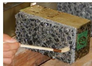
図-2.2 含浸系塗布材の塗布状況
