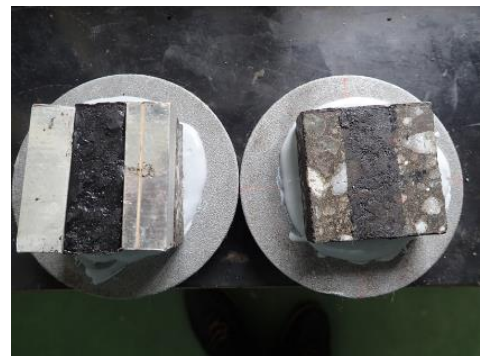
写真-6.3 境界面でののはがれ(加熱型高弾性、-20℃)
