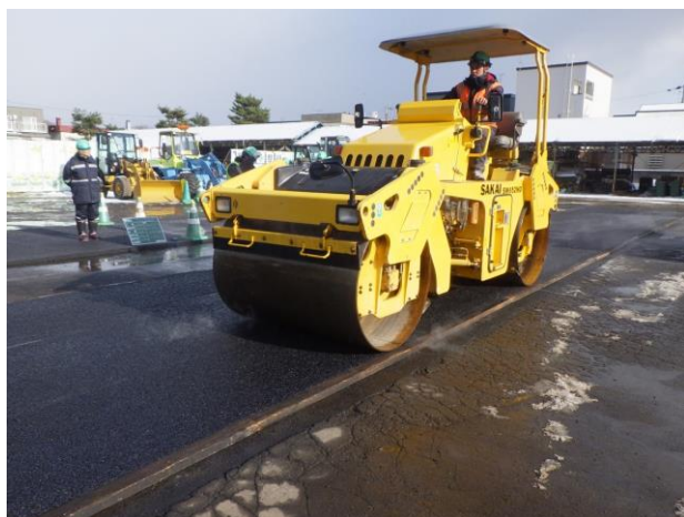
写真-2.1 水平振動ローラ（7t 級）
