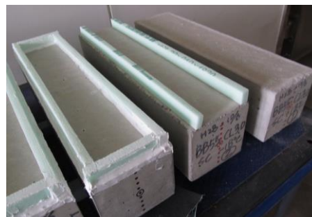
写真-4.1 供試体の打設面への枠の据え付け状況
