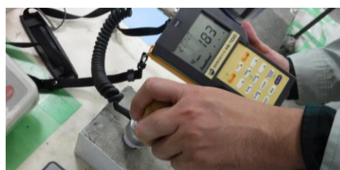
写真-4.3 電気抵抗式的水分計による測定状況
