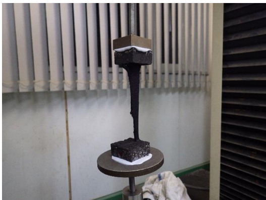
写真-6.5 引張試験の破断形態（下面で破断）
