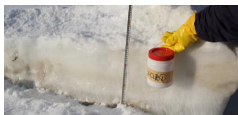
写真-2.1 調査の様子（固形分の付着が理解できる）
