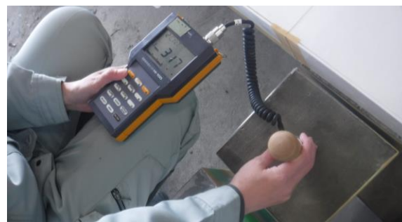
図-5.4 電気抵抗式水分計による測定状況
