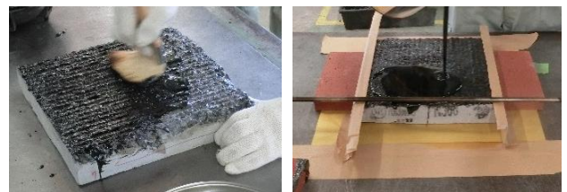
写真-4.3 防水材の塗布状況（増量）
