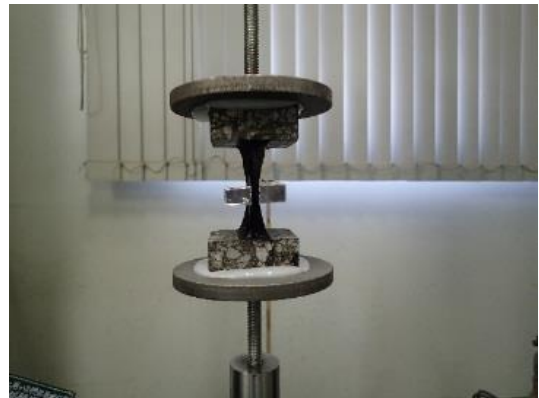
写真-6.2 引張接着力試験状況(特殊目地材、-20℃)
