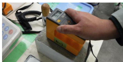
写真-4.2 高周波容量式的水分計による測定状況
