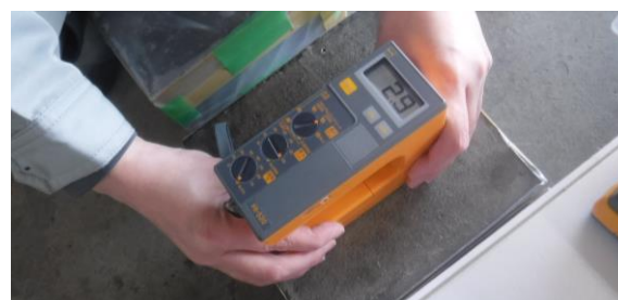
図-5.11 高周波容量式水分計による測定状況
