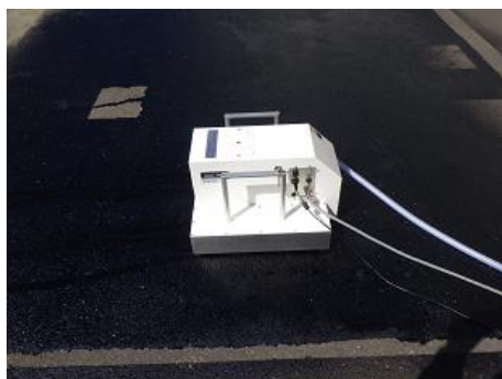
写真-3.2 DF テスターによるすべり抵抗測定
