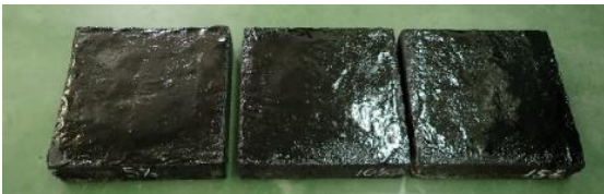
写真-6.7 IH加熱試験用供試体
