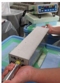
写真-4.3 超音波伝播速度の測定状況
