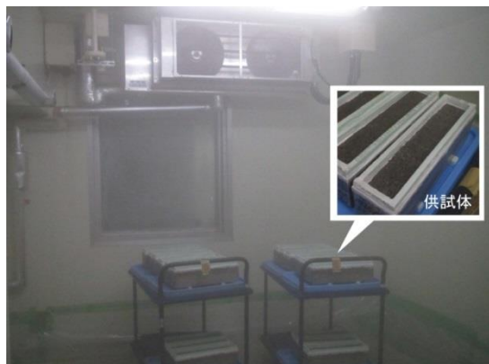
写真-3.1 凍結融解試験の様子
