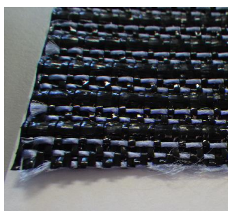
写真-4.1 ウィッキングファブリック排水材
