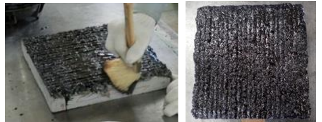
写真-4.2 防水材の塗布状況（標準）
