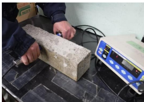
写真-5.4 超音波による相対動弾性係数の測定状況
