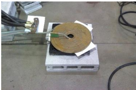
写真-6.8 IH加熱実験状況
