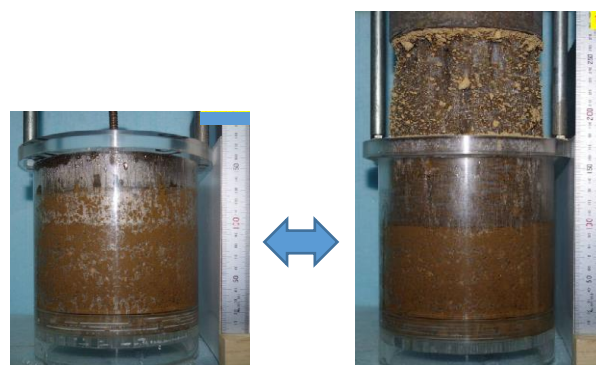
写真-3.1 凍上試験前後の供試体外観
