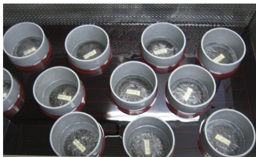
写真-2.2 円柱状供試体の凍結融解状況
