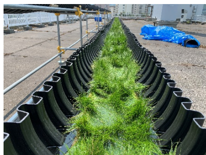
写真-5 仮設排水路を使用した蒸発散量の促進効果を確認するための実験状況 左：水路のみ（blank） 中：水路とマツバイ 右：水路とマツバイと不織布
