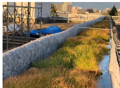
写真-5 仮設排水路を使用した蒸発散量の促進効果を確認するための実験状況 左：水路のみ（blank） 中：水路とマツバイ 右：水路とマツバイと不織布
