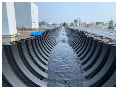
写真-5 仮設排水路を使用した蒸発散量の促進効果を確認するための実験状況 左：水路のみ（blank） 中：水路とマツバイ 右：水路とマツバイと不織布
