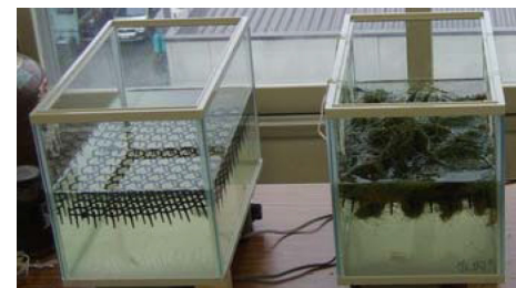
写真-1 屋内の水槽での実験状況 左：ブランク水槽 右：マツバイ敷設水槽
