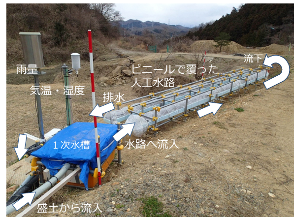
写真-4 屋外の人工水路での実験状況
