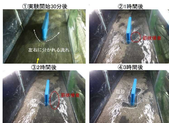
図-4.3 Case 0(無対策)の実験中に橋脚前面から撮影した斜め写真(黒:軟岩モルタル,白:珪砂)
