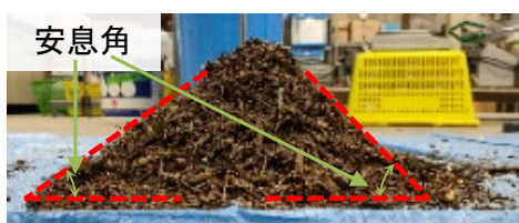
図-5 (b) 破砕機通過後草木破砕物の安息角
