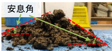
図-5 (a) 破砕機通過後し渣の安息角
