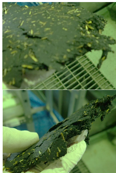
(b) 脱水ケーキ中にバイオマスが混合されている様子
