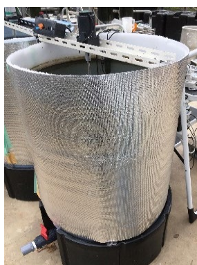
写真-1 上部開放タンク型培養槽(200 L)
