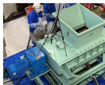
図-2 実験に供したし渣破碎機
