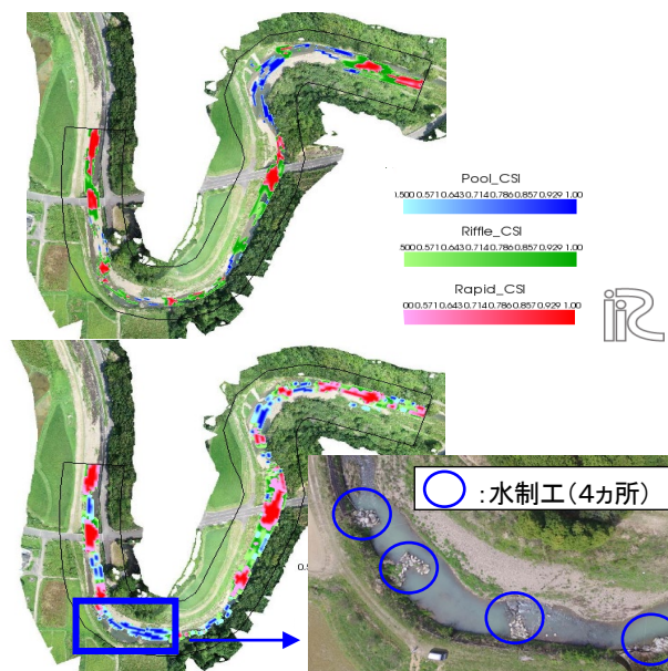
図-8 水制工なし (上図) と水制工あり (下図) の瀬淵分布の判別例
