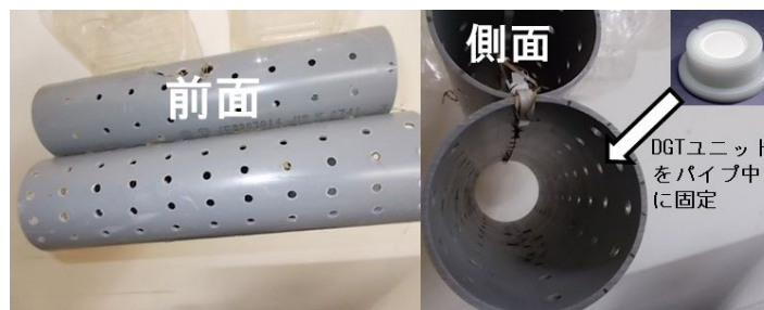
図-14 DGTユニット取り付け用の観測機材
