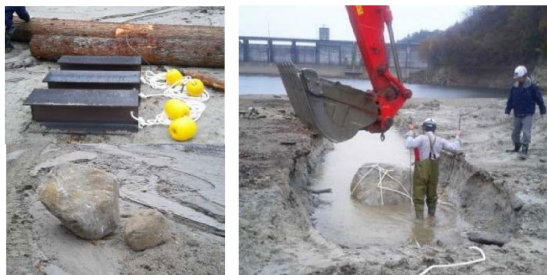
図-16 試料の埋設状況写真 (水位低下時)
