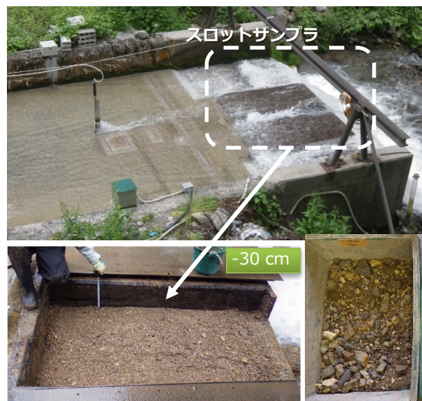
図-2 観測水路のスロットサンプラ（上）と捕捉された流出土砂の回収状況（左下）及び回収した土砂試料（右下）
