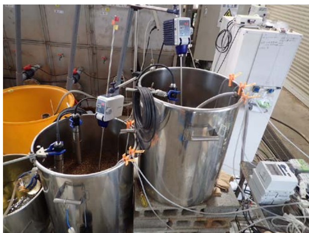
写真-1 流動型担体処理実験装置の概要
