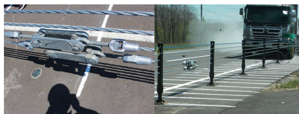
写真-45 緊急開放金具の確認試験
