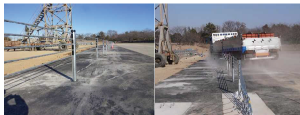
写真-1 ワイヤロープ式防護柵（左）と性能確認試験（右）
