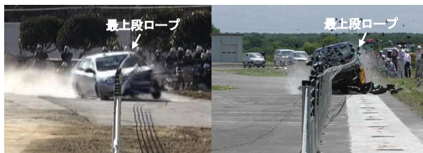
写真-41 乗用車衝突状況(左:平成24年,右:令和2年)
