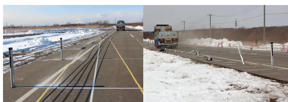
写真-7 車両衝突後の状況 (左: CASE4, 右: CASE5)
