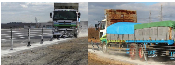
写真-32 大型車衝突時の状況
