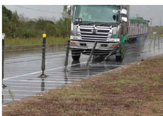
写真-14 橋梁用支柱衝突状況
