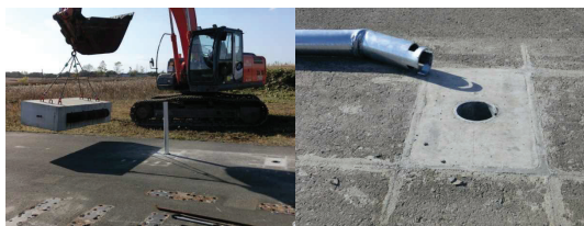
写真-26 重錘衝突試験（左）と試験後の状況（右）
