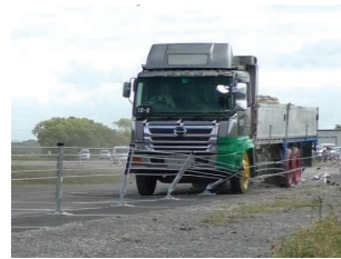
写真-22 支柱衝突時の状況
