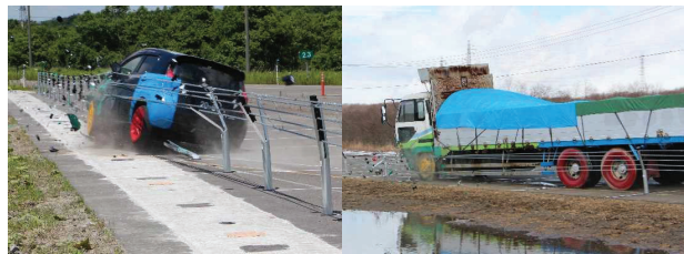
写真-40 衝突状況(左: 乗用車、右: 大型車)
