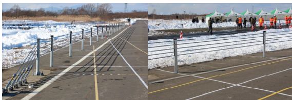
写真-5 ワイヤロープ設置状況 (左: CASE4, 右: CASE5)
