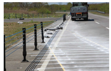
写真-13 実車衝突試験後の状況
