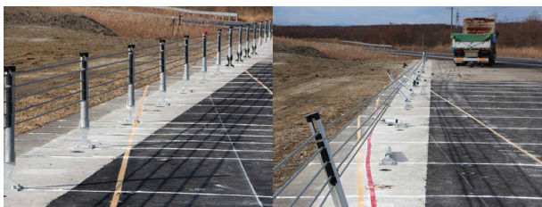
写真-33 衝突前（左）と衝突後（右）の状況
