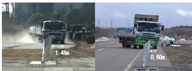
写真-42 衝突時はみ出し状況(左:平成24年,右:令和2年)
