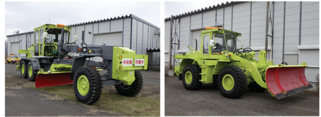
図-58 試験に使用した車両 (左：除雪グレーダ 右：除雪ドーザ)
