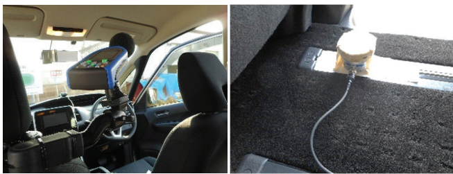
図-33 車内騒音（左）・車内振動（右）の測定状況
