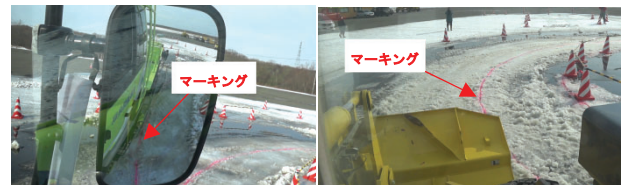
図-49 マーキング試験の除雪走行状況
