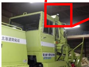
写真-14 カメラ設置状況
