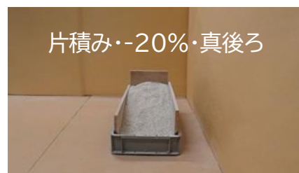
図-11 容量に差があるのに画像に差がない例 (真後ろから)
