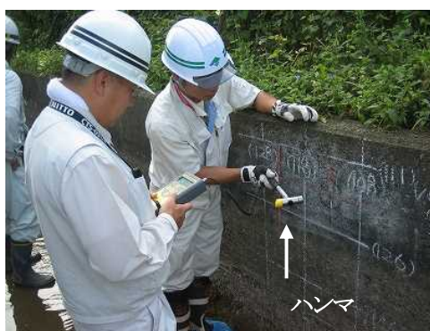
図-21 機械インピーダンス法による測定状況 64)
