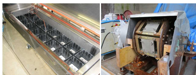
凍結融解試験 水流摩耗試験 図-48 凍結融解試験および水流摩耗試験
