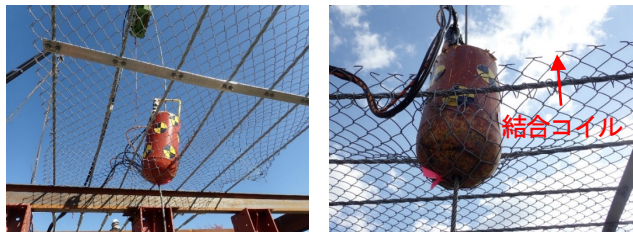
(a) 中央部での捕捉 (b) 端部での捕捉 写真-5 結合コイルにより中央部と同等の捕捉性能(金網端部のめくり上がり予防)
