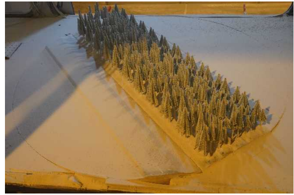
図 93 吹き溜まり状況（ネット柵有り）道路側
