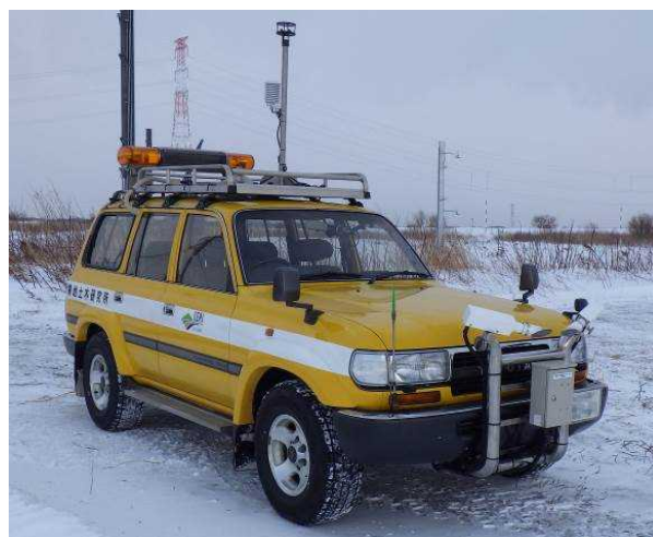
図 2 視程障害移動観測車
