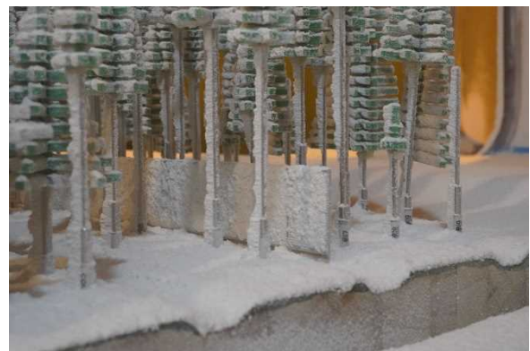
図 95 ネット柵に付着した模擬雪
