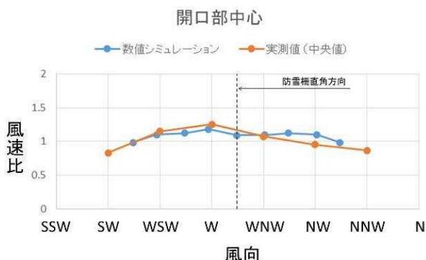
図 24 開口部中心における風速比の実測値と計算値
