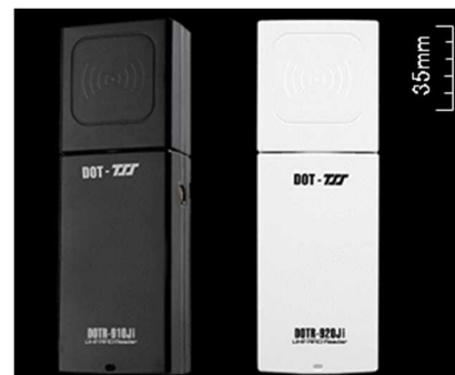
写真-2 読取装置（UHF 帯リーダ）
