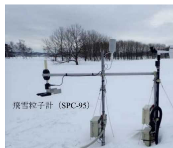
図 32 基準点 (No.0) に設置した飛雪粒子計
