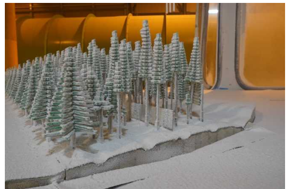
図 94 樹木模型に付着した模擬雪
