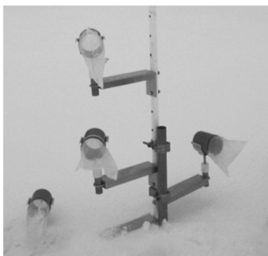
図8 筒型ネット式吹雪計
