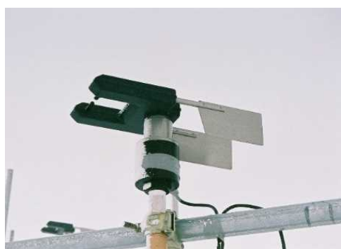
図9 Snow Particle Counter (SPC) の外観
