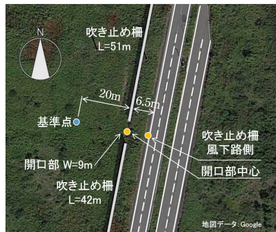
図 17 観測機器設置状況
