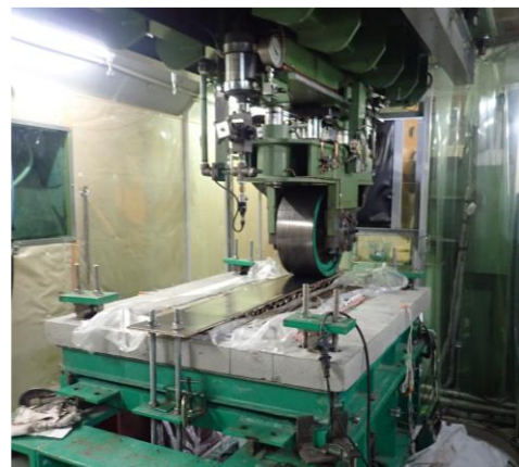
写真-4 小型輪荷重走行試験機
