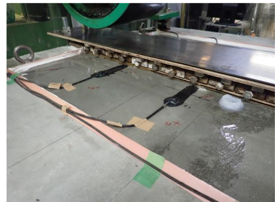
写真-5 滞水時の試験体の状況
