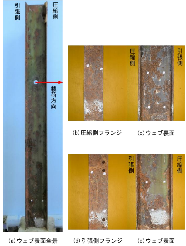
写真-19 試験体の外観状況 (劣化材 5)
