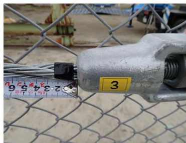
写真-27 ワイヤロープのすべり出し
