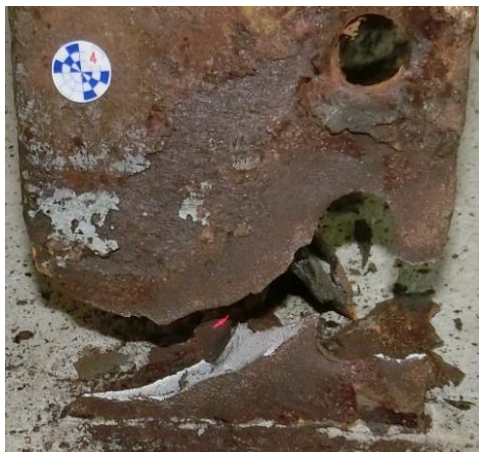
図-23 劣化材4のフランジの腐食と載荷前後の状況
