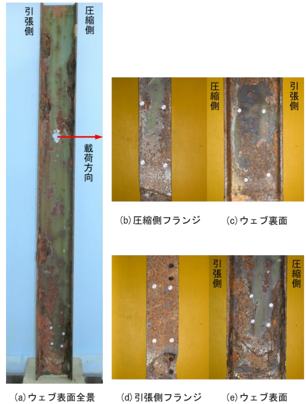
写真-21 試験体の外観状況 (劣化材 7)
