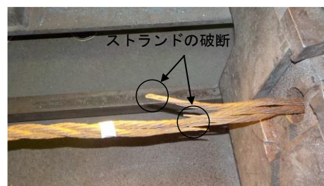
写真-7 試験後の状況 (Case2-5)
