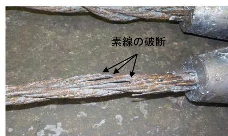
写真-6 試験後の状況 (Case1-3)
