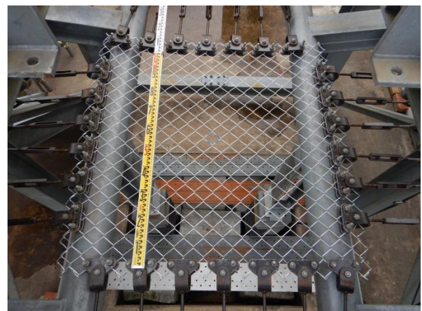
写真-10 金網部材試験装置
