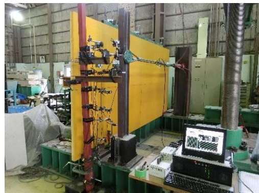
写真-23 静載荷実験状況
