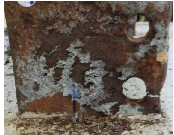
図-24 劣化材2のフランジの腐食と載荷前後の状況
