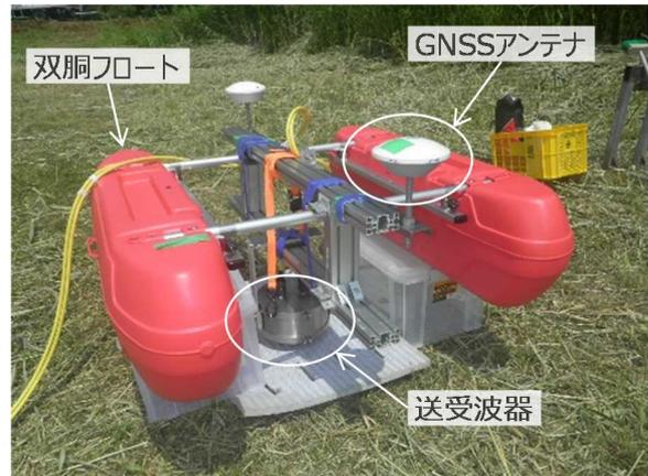
写真-9 双胴フロートへの送受波器取り付け状況
