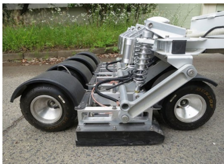
図-15 車両牽引型多チャンネル GPR
