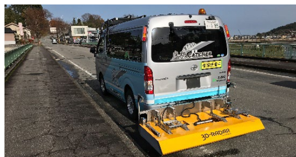
写真-7 電磁波レーダ計測状況
