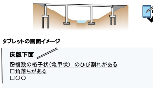
図-6 診断AIシステムの画面の例
