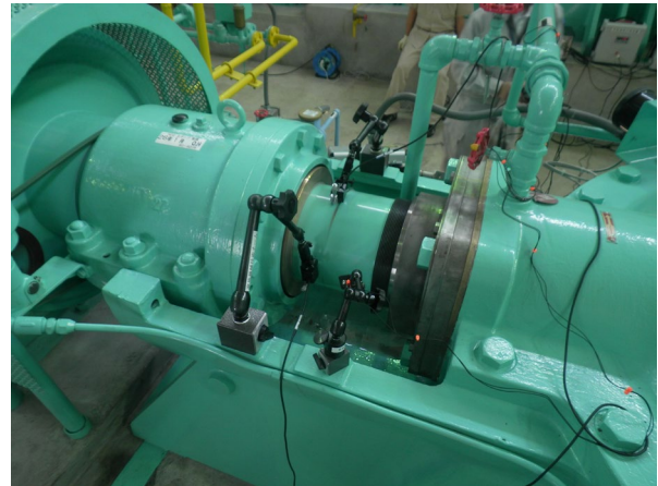
写真-5 マグネット式架台による計測
