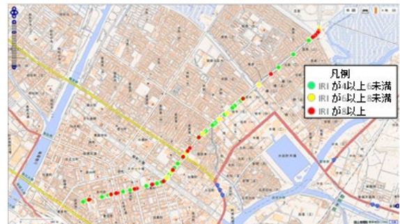
図-19 IRI 計測マップ表示の一例(1)
