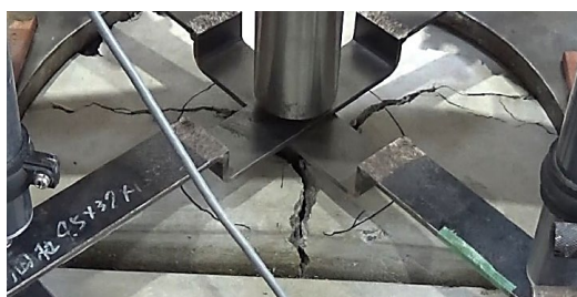
写真-6 割裂破壊の例
