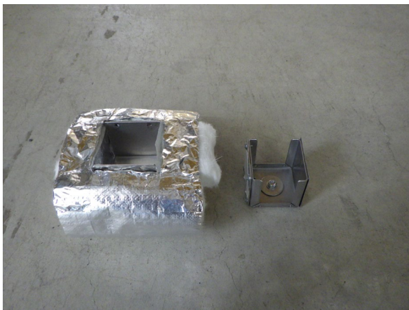
写真-9 加速度センサ用断熱加工治具②
