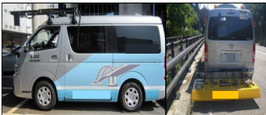
写真-3 車載式電磁波レーダ外観
