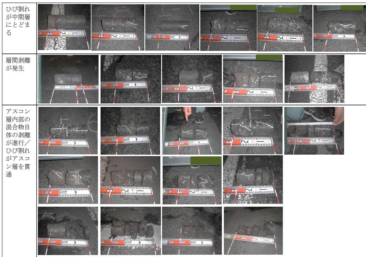
図-2 コア抜き調査結果
