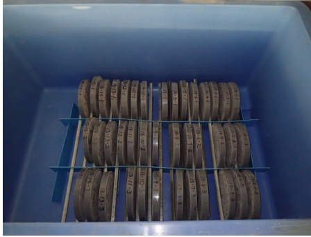
図-2 浸せき試験時の試験片設置状況
