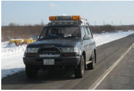
写真-5 IRI 計測装置搭載車両
