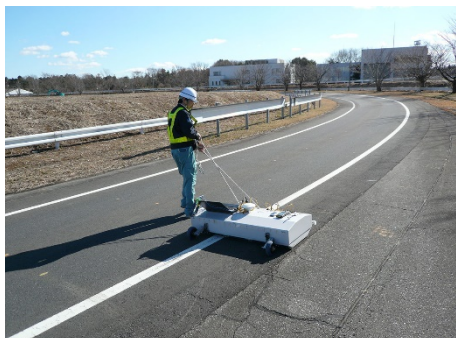
図-14 ハンディ型多チャンネル GPR
