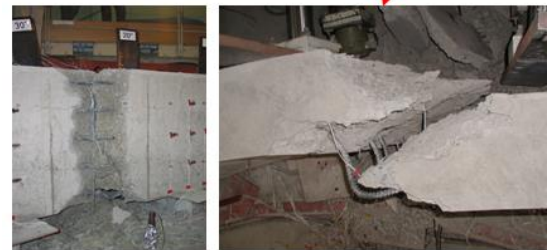
写真-4.2.1 覆工載荷実験
