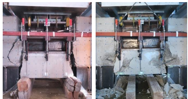
写真-4.2.2 要素実験 (左: 鋼繊維補強 右: 鉄筋補強)
