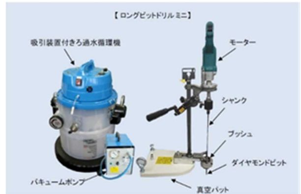
写真-7 微破壊コンクリート内部検査機器（削孔）
