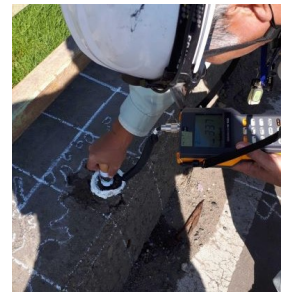
写真-1.4 電気抵抗式水分計による測定状況
