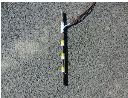
写真-3.1 舗装体に埋設した熱電対
