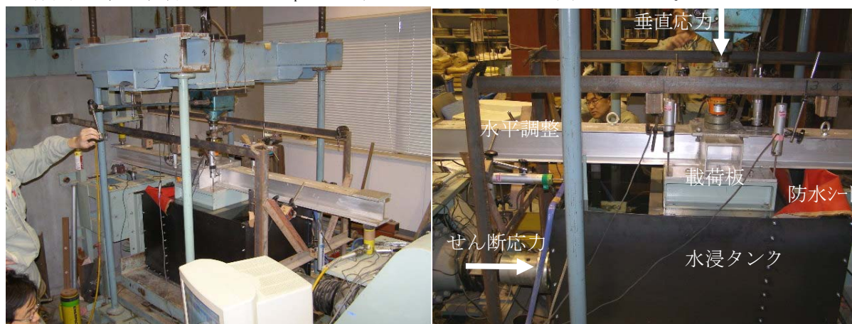
(a) 大型一面せん断試験装置全体
