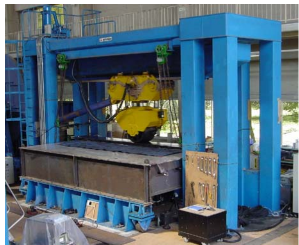
写真-1 輪荷重走行試験の状況
