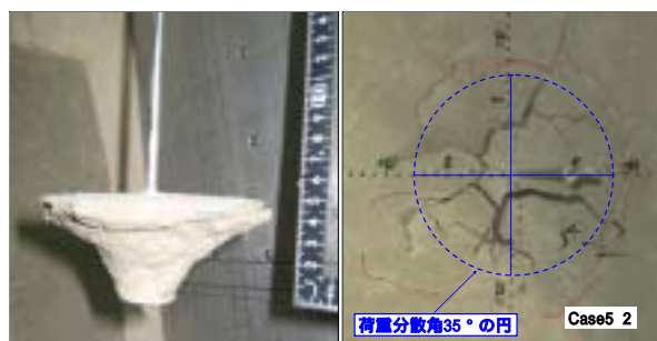
図 15 引抜き試験後の供試体の状態と亀裂の発生状況
