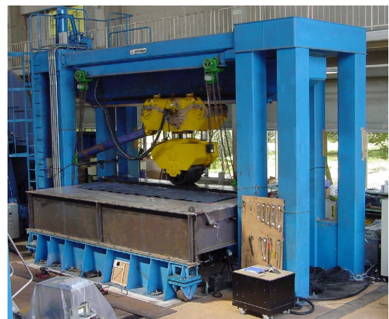
写真-1 輪荷重走行試験の状況
