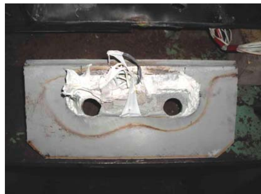
写真-8 長孔L型当て板の試験後接合面(ウェブ側)
