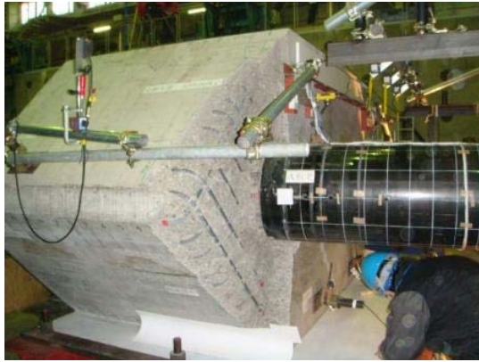
写真-3.1 フーチング損傷状況 (Case 1)
