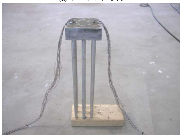
(b) 杭とフーチングを結合した状況 写真-4.2 杭基礎模型
