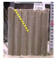
図-20 固化体の損傷状況 (上：平面図, 下：側面図)
