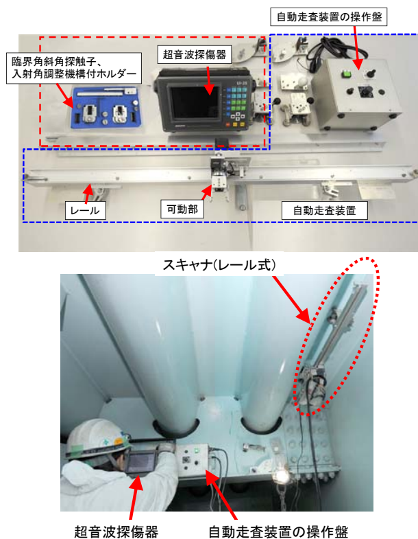
写真-5.1 超音波探傷装置の構成の例と現場での適用状況
