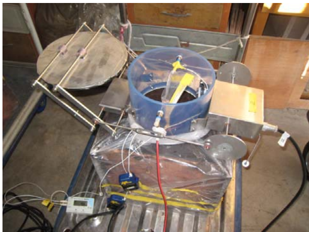
図 34 開閉式チャンバー設置状況
