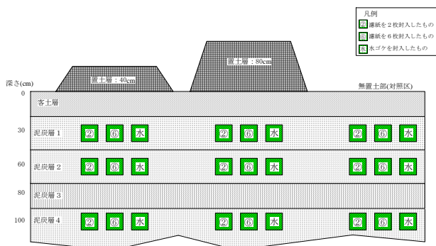
図17 置土直下へのリターバッグ埋設の模式図
