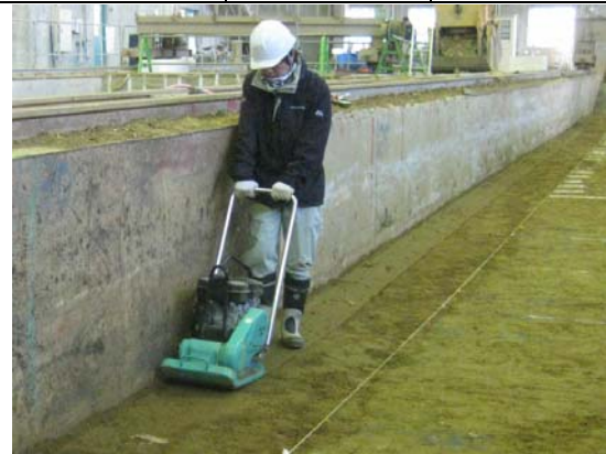
写真-6 締固め回数試験状況
