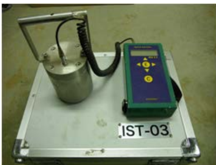
写真-7 超小型動的平板載荷試験装置
