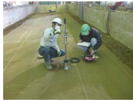
写真-8 小型FWD試験状況
