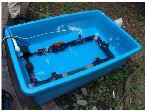
写真6 付着藻類による溶存酸素濃度の変化を測定可能な密閉型管路
