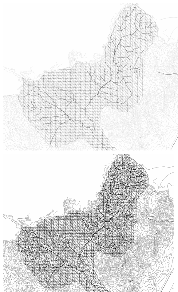
図5 計算に用いた構造メッシュ(上)・非構造メッシュ(下)(上流側を部分的に表示)
